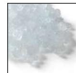
Flockeneis wird in einem stehenden, doppelwandigen, wartungsfreien Edelstahlverdampfer mit rotierender Schnecke hergestellt. Es entsteht Eis in seiner natürlichsten Form, ca. -0,5° C kalt. Die Anwendungsbereiche sind vielfältig.
